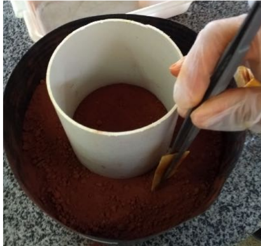
Figura 4: Resinas sendo dispostas verticalmente no vaso.
