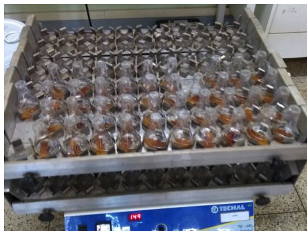
Figura 5: Erlemeyer com resinas e solução extratora levados ao agitador por 1 hora.
