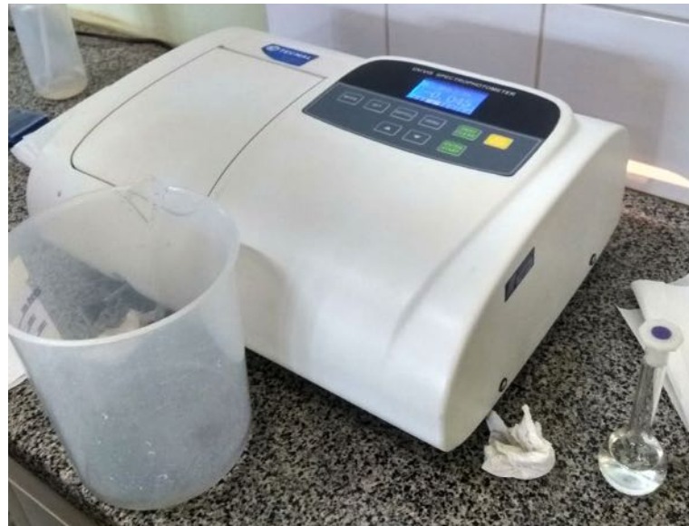
Figura 7: Leitura e quantificação de fósforo pelo espectrofotômetro.
