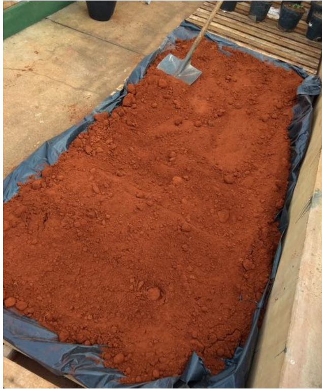
Figura 1: Exposição do solo ao ar para secagem, na estufa do UNIPAM.
