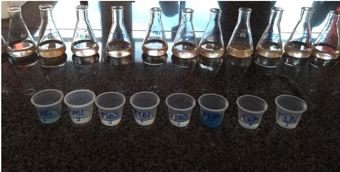
Figura 6: Solução em repouso com reagente de trabalho para posterior quantificação de fósforo.
